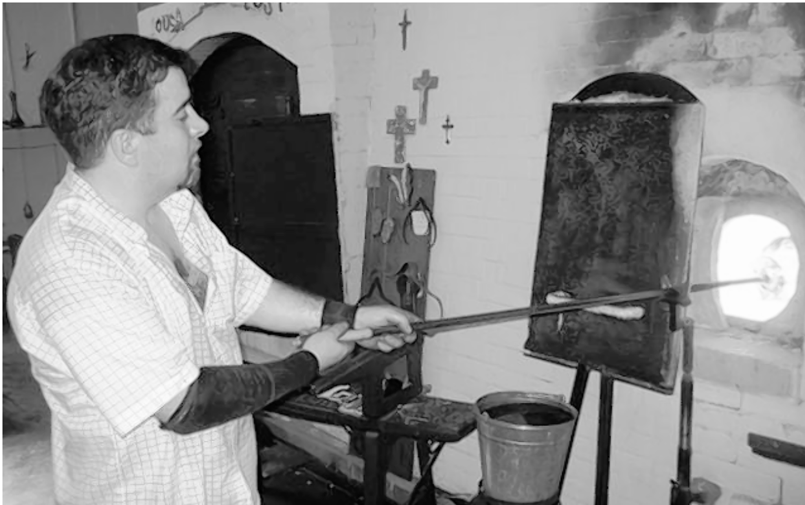
Mit einem langen Metallrohr holt Fernando Costa die Rohmasse für eine Glasvase aus dem großen Schmelzöfen.
