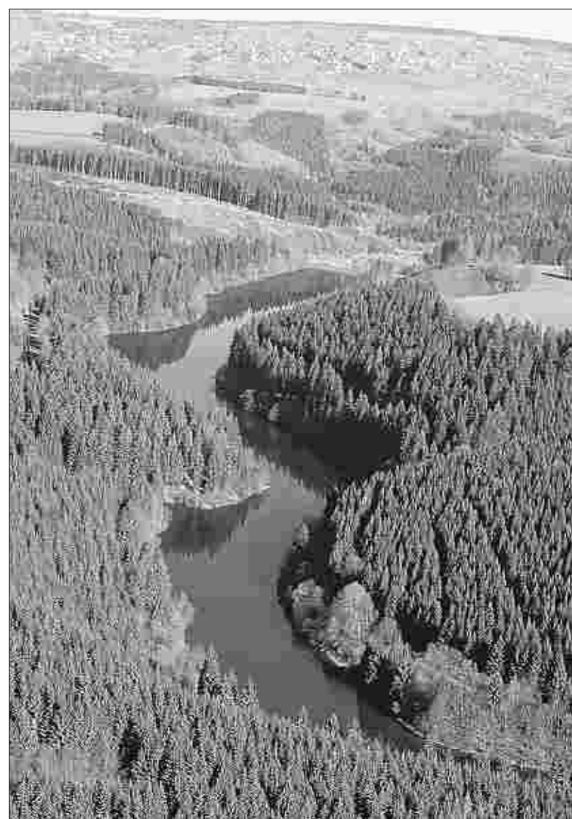
800 000 Kubikmeter Wasser fasst die Perlenbachtalsperre, im Schnitt fallen hier jährlich 1185 Liter je Quadratmeter Niederschlag. Das Einzugsgebiet des Stausees ist 64 Quadratkilometer groß und liegt überwiegend auf belgischem Gebiet. Foto: Heiner Schpepp
